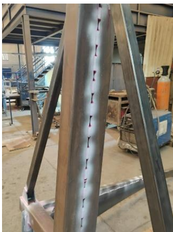
Imagen 27. Ensayos por líquidos penetrantes.
