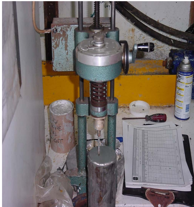
Figura III.2.14. Prueba de Veleta Miniatura.
