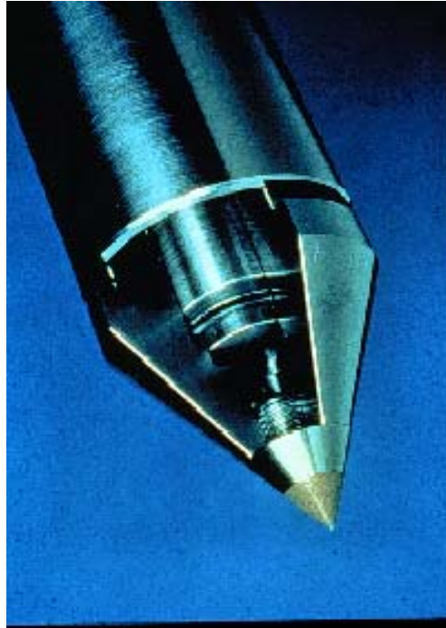
Figura III.2.4. Punta del Piezocono Penetrómetro.
