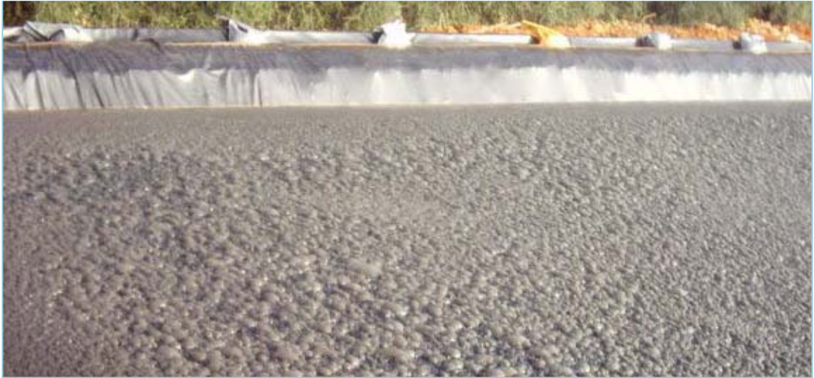
Figura 4.7 burbujas de gas metano a las 18 horas de haber llenado el digestor
