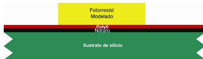
Figura B.2 El Fotorresist es dibujado con litografía por exposición de luz UV a través de la primer máscara.
