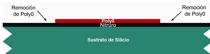
Figura B.3 La remoción con plasma es utilizada para eliminar el polisilicio no deseado.
