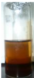
Figura 3.60. Formación de precipitados en soluciones concentradas de fenol tratadas mediante fotocatalisis
