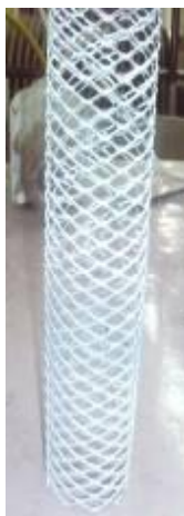
Figura 2.8. Malla de titanio usada como ánodo (Ti/TiO 2 )
