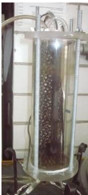
Figura 2.3. Reactor electroquímico funcionando bajo el mecanismo de la oxidación anódica
