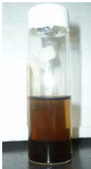
Figura 3.48. Precipitados en solución de fenol de 1000 mg/L
