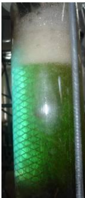
Figura 3.61. Formación de espuma en soluciones concentradas de fenol con el reactor de fotocatalisis
