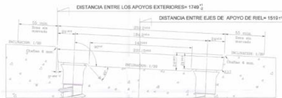
DETALLE DE LA MESA DE APOYO DE RIEL
