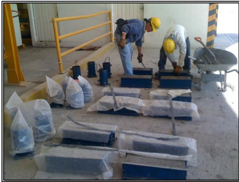
Figura N° 21. Verificación de laboratorio toma de muestras
