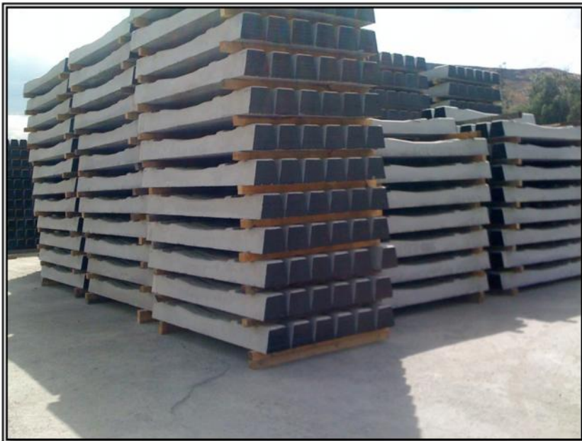
Figura N° 23. Estibado de durmientes monobloque pretensado en 12 camas.
