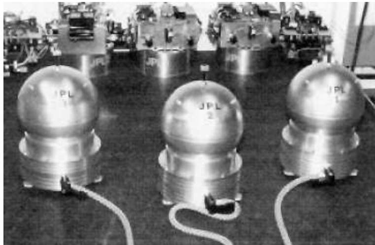
Figura 1.21. Cojinetes neumáticos esféricos huecos, con movimiento de 360^\circ en tres ejes.
