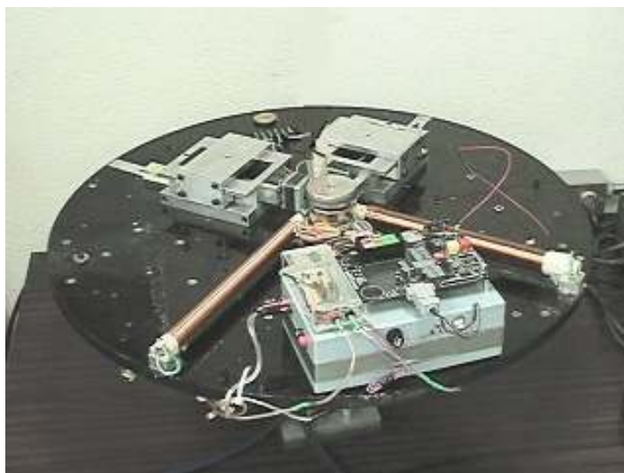
Figura 6.15 Plataforma de simulación con dos bobinas magnéticas en los ejes X,Y y una rueda inercial en el eje Z. También se aprecian los componentes de balanceo automático y los circuitos de potencia y transmisión inalámbrica.
