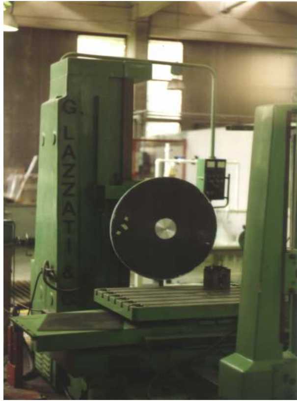
Figura 5.6. Maquinado de la plataforma para dar dimensiones y acabado.
