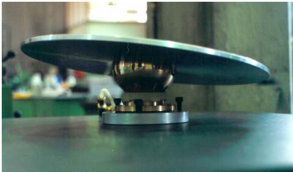
Figura 1.18. Simulador de un medio sin fricción, basado en una plataforma suspendida sobre un cojinete neumático esférico.
