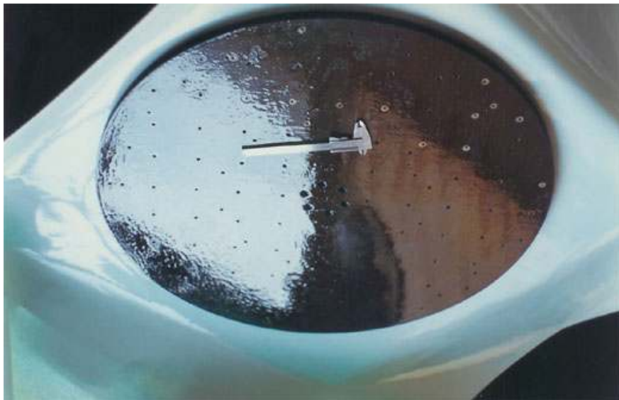
Figura 5.7. Plataforma de fibras de carbono-epoxy terminada.
