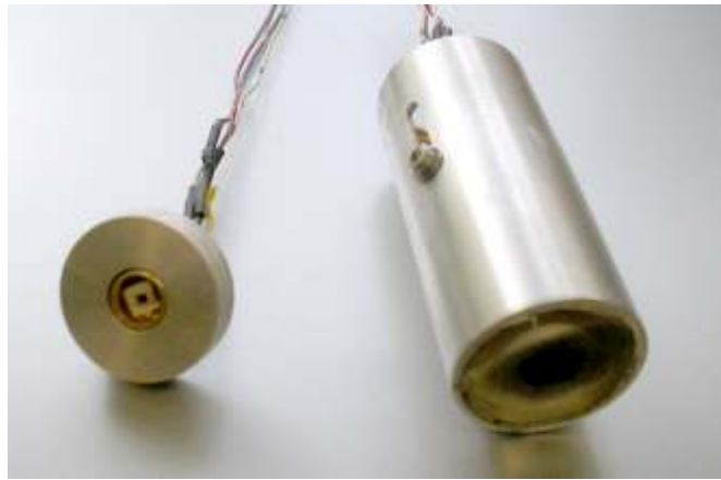
Figura 2.9. Sensor de Tierra estático basado en un detector IR de selenuro de plomo.
