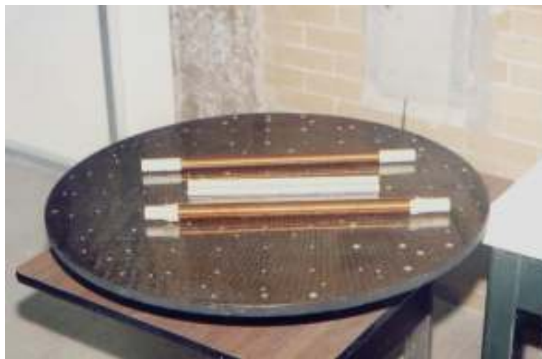
Figura 1.13 Las bobinas magnéticas imponen pares externos al satélite, y también son utilizadas para evitar la saturación de las ruedas inerciales.
