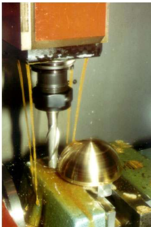
Figura 5.15. Un detalle del maquinado de la primera semiesfera fabricada para este proyecto, en la máquina de control numérico Emco VMC-300 .
