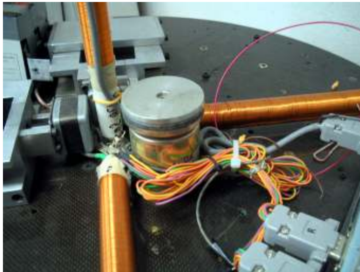
Figura 2.20. Localización de la rueda sobre el eje Z, en la plataforma de simulación.
