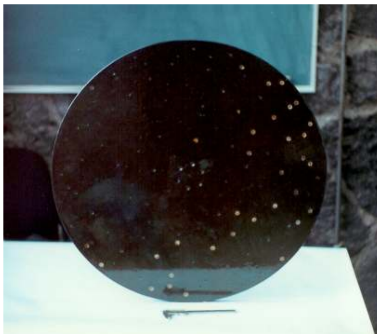
Figura 1.26 Plataforma construida con fibras de carbono.
