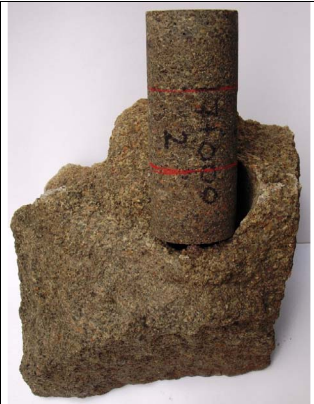
Fotografía A4.4 Extracción de núcleo de roca antes de los ensayos de prueba puntual y de compresión simple con medición de deformabilidad.
