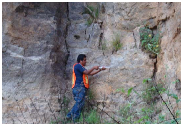
Fotografía V.5 Toma de datos con martillo de Schmidt
