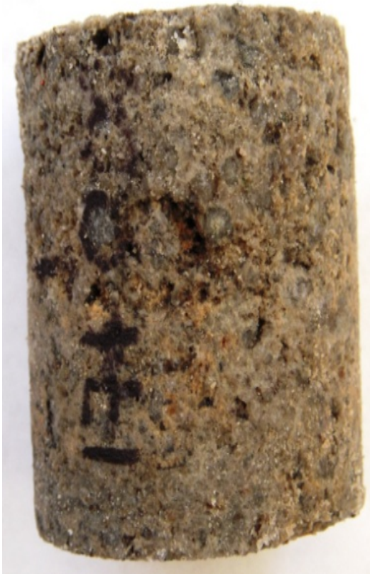
Fotografía A4.13 Muestra de Dacita antes del ensaye a carga puntual, muestra M-1 (Km. 17+000).
