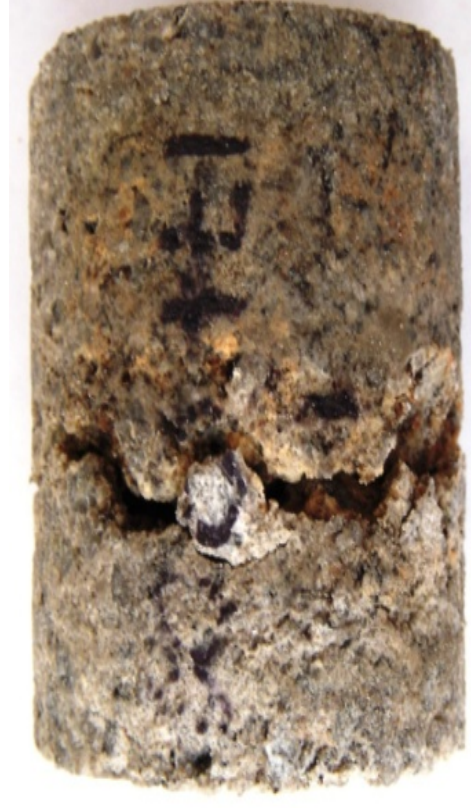
Fotografía A4.14 Detalle del modo de falla de la muestra M-1 (17+000), sometida a carga puntual.
