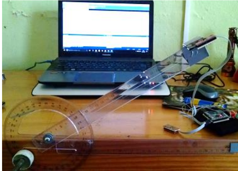
Figura 42 Medición de ángulos de los acelerómetros con un trasportador
