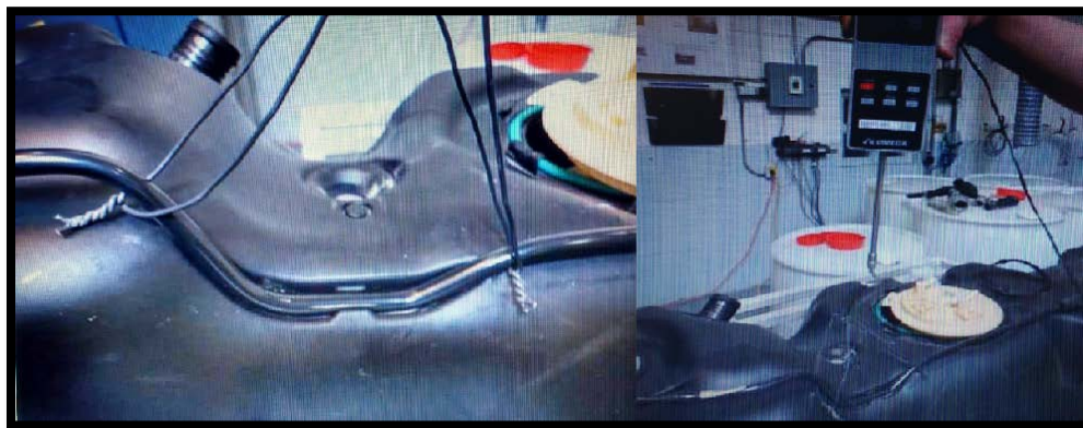
Ilustración 17. Prueba de retención en los tanques.
