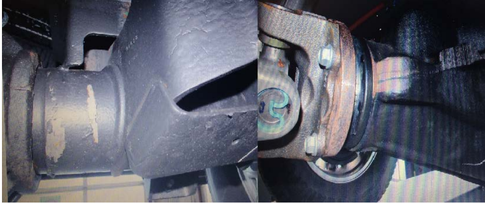
Ilustración 8. Desprendimiento de pintura en ejes e inicio de corrosión.
