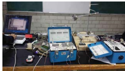
Figura 2.21. Prueba experimental de Estabilidad; indicador de deformación modelo P3 de Micro-measurements, computadora para adquisición de datos y manipulador instrumentado con pesa.
