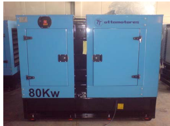
FIG 4. Caseta acústica planta 80 kW.
