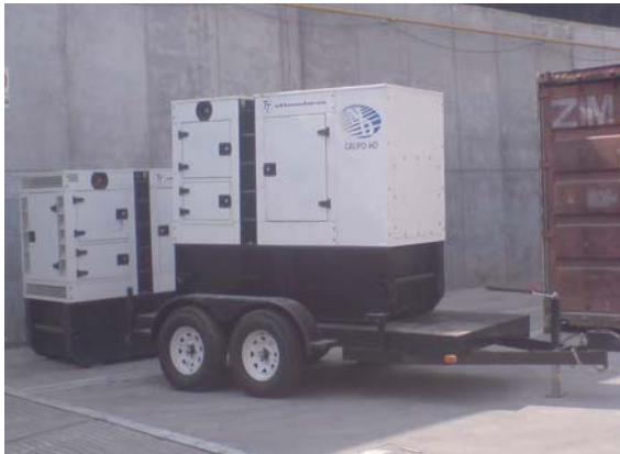
FIG. 5 Equipo con caseta y remolque.
