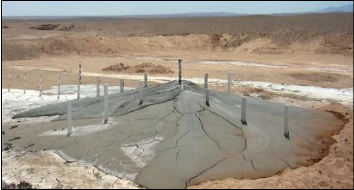
Figura 4. 9. Disposición de jales espesados en unidad Esperanza. Fuente: Esperanza Thickened Tailings Project (Cacciuttolo & Marinovic, 2022).
