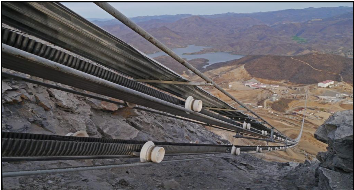
Figura 4. 52. Sistema RopeCon implementado en las operaciones de Torex Gold Resources en México. Fuente: 2024 RESPONSIBLE GOLD MINING REPORT ( Torex Gold Resources, 2025 ).
