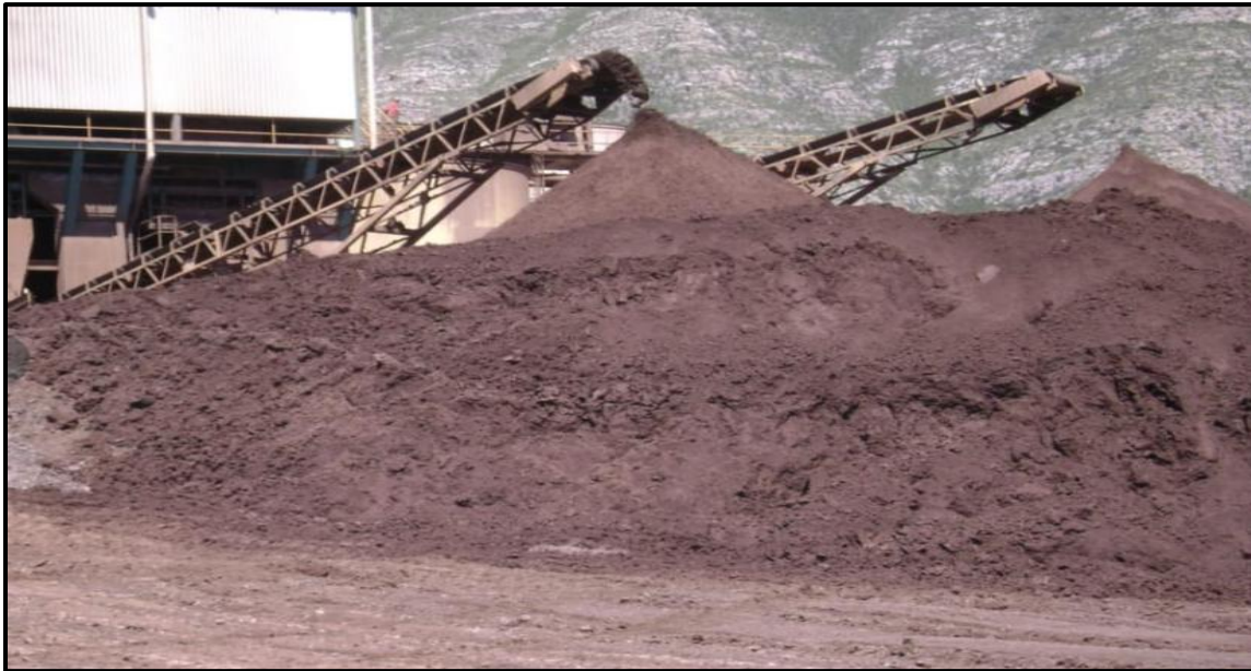
Figura 4. 13. Disposición de jal filtrado en Mina La Encantada. Fuente: Jales Espesados y Jales en Pasta ( First Majestic Silver, 2024 ).
