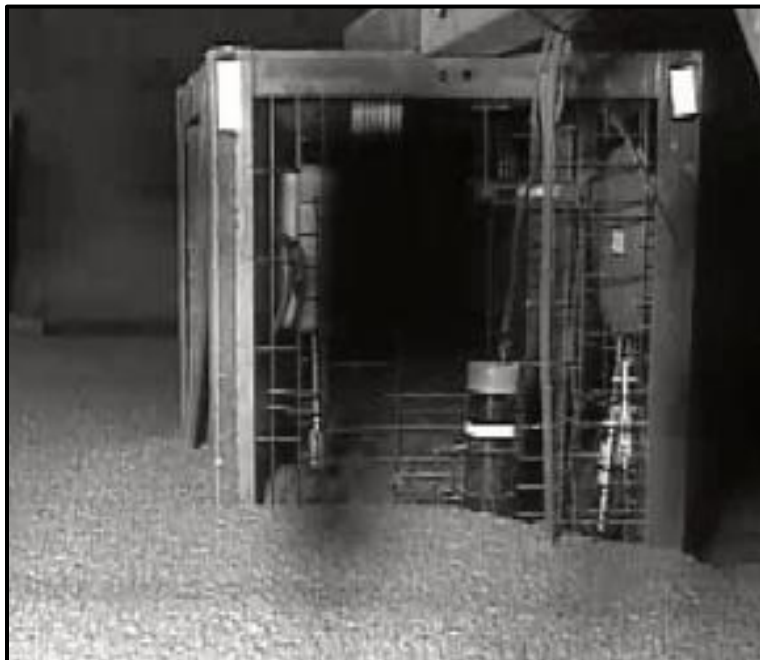
Figura 4. 4. Instrumentación colocada al tapón del relleno para evaluar la continuidad del vertido. Fuente: Paste backfill continuous pour: Red Lake operations case study (Oke et al., 2021).
