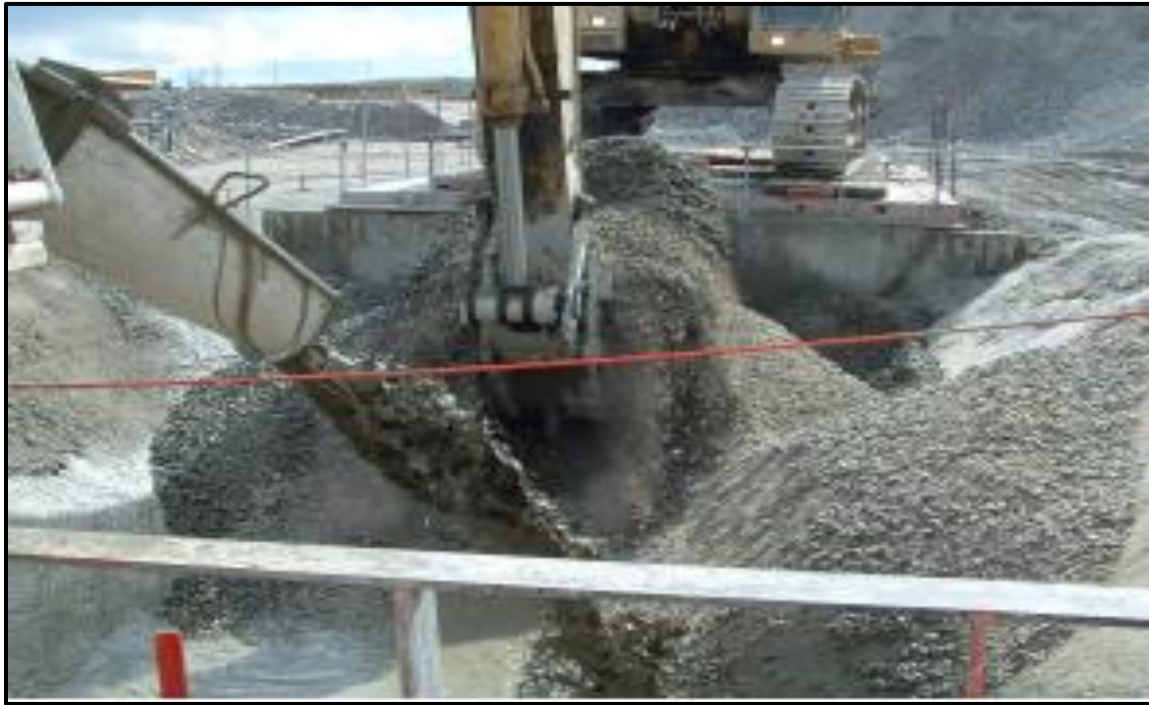
Figura 4. 5. Mezcla y vertido de los jales como pasta cementada en tajo. Fuente: Properties of cemented rockfill used in an open pit mine (Basanta et al., 2020).
