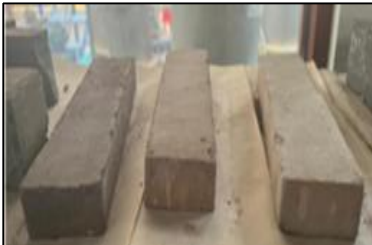
Figura 4. 17. Ladrillos fabricados a partir de jales de oro sin tóxicos. Fuente: Aplicación de la Economía Circular en la Industria Metalúrgica Minera para la Recuperación de oro y la Producción de Ladrillos a partir de Relaves (Yoplac et al., 2024).
