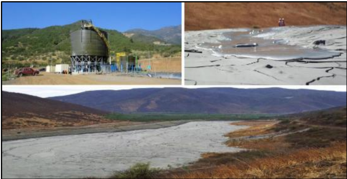
Figura 4. 10. Disposición de jales en pasta de unidad Las Cenizas, Chile. Fuente: Sustainable Management of Thickened Tailings in Chile and Peru: A Review of Practical Experience and Socio-Environmental Acceptance (Cacciuttolo & Marinovic, 2022).
