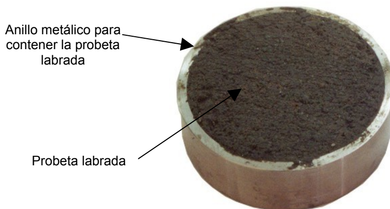
Fotografía III.2.4.2.2 Labrado de la muestra de Suelo para obtener la probeta contenida en el anillo metálico
