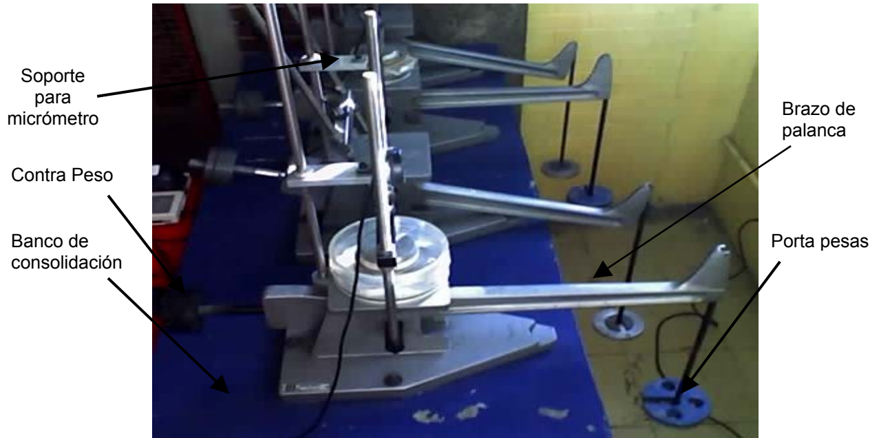
Fotografía III.2.4.1.1 (A) Consolidómetro (Vista lateral).
