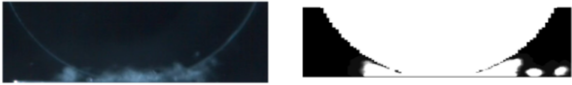
Figura IV.1: Comparación de comportamiento experimental y simulación. Las zonas claras representan el vapor
