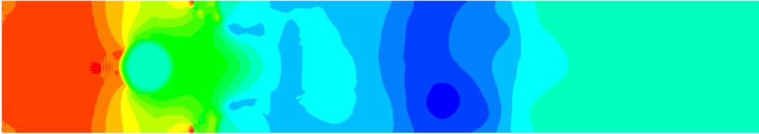
Figura 5.7 Patrones de presión vistos desde el plano K=32 ubicado entre dos placas del intercambiador, a) Geometría 2, b) Geometría 3, c) Geometría 4. En ellas se observan a la misma escala y las tres geometrías con la incorporación de varillas, comparando con el caso base.
