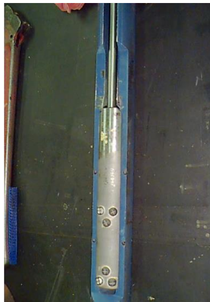
Fig. 3.22 Parte inferior de un TTW, muestra los slips y la configuración de la varilla.
