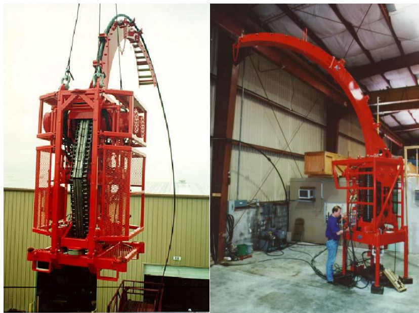
Fig. 2.19 Configuraciones comunes de arcos guía.
