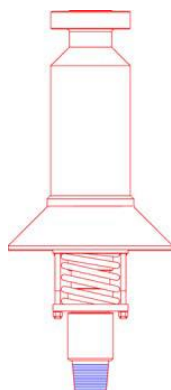
Fig. 2.14 Conector de liberación hidráulica.
