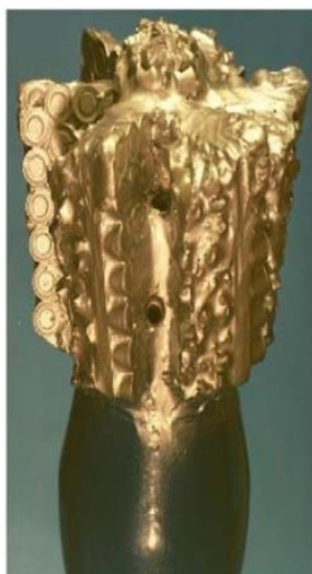
Fig. 3.14 Molino de ventana "metal muncher".
