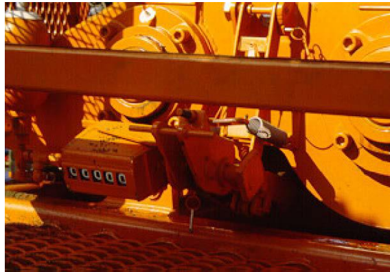
Fig. 2.18 Contador mecánico de profundidad.
