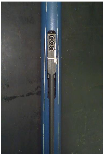
Fig. 3.21 Parte superior de una TTW, muestra el bloque de corte inferior.
