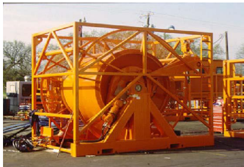
Fig. 2.20 Carrete de tubería vacío (Configuración marina).
