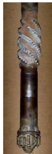
Fig.3.15 Molino de ventana combinado con sarta molino.
