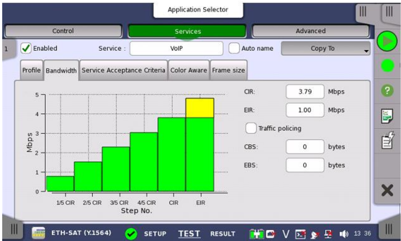
Figura 4.6 - Capturas de pantalla del equipo ANRITSU para la configuración del primer servicio, prueba Y.1564.
