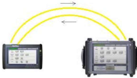
Figura 4.3 - Esquema de conexiones para las pruebas iniciales de servicios MPLS.
