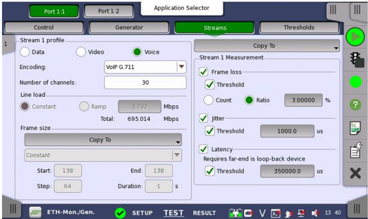
Figura 4.8 - Capturas de pantalla del equipo ANRITSU para la configuración del primer servicio, prueba MPLS.
