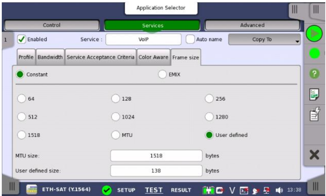
Figura 4.7 - Capturas de pantalla del equipo ANRITSU para la configuración del primer servicio, prueba Y.1564 (continuación).
