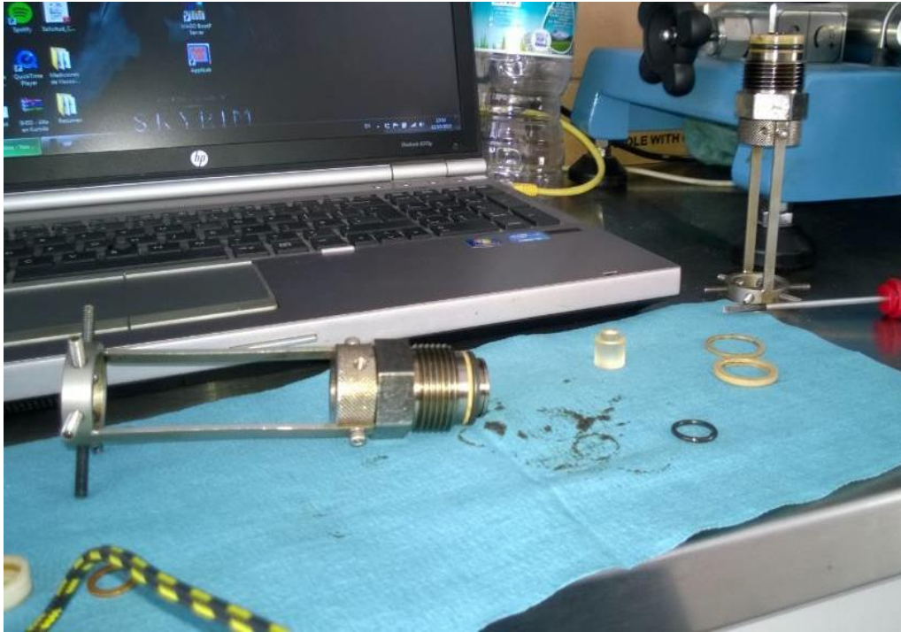
Figura 8 Piezas del viscosímetro en proceso de limpieza.
