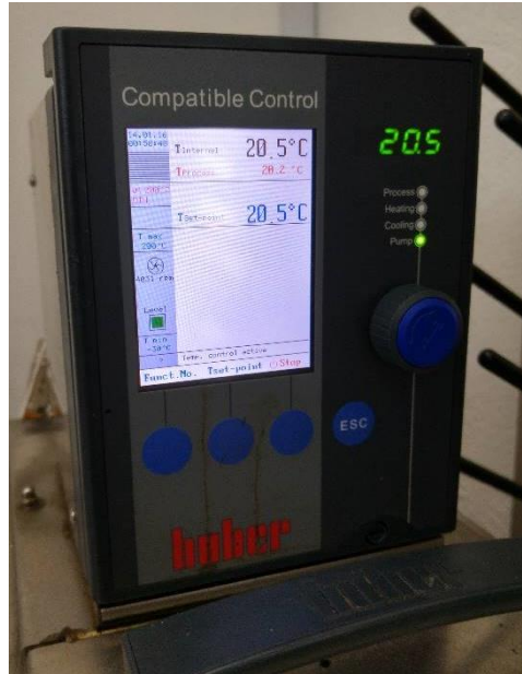
Figura 5 Panel de control del baño regulador de temperatura.
