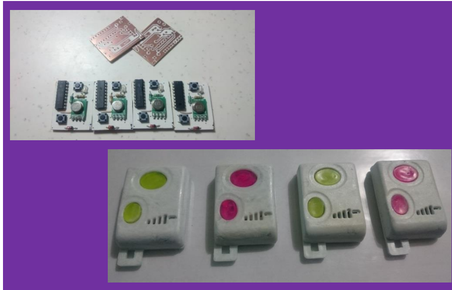
Figura 2.17. Diseño final de la placa emisora. En este caso a la placa se le añadió un plano de tierra para disminuir la interferencia electromagnética, se retiró la máscara antisolder, los componentes ahora fueron de agujeros pasantes y diseño del control fue modificado.
