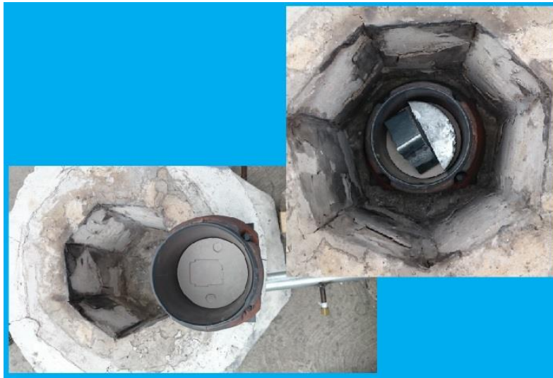
Figura 5.2. Se muestra claramente el cerámico que copiara el negativo de nuestro molde y también la cantidad de material a fundir.
