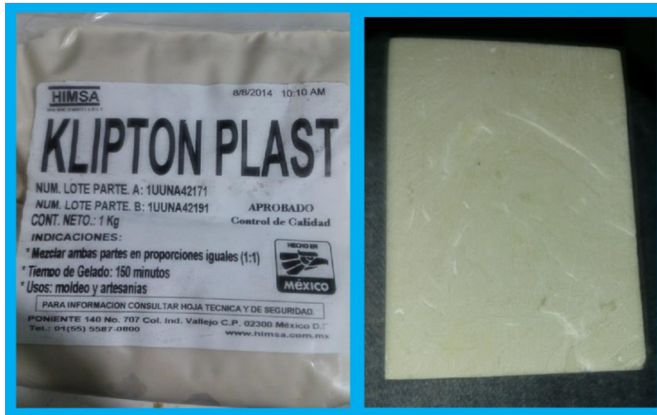
Figura 4.1. Se puede apreciar el estado físico del material antes de ser mezclado y en consecuencia después de la mezcla, su estado sólido que nos brinda la ventaja de realizar un tocho de esta masilla.
