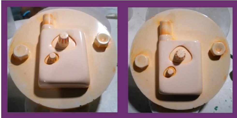
Figura 4.7. Se puede apreciar una muestra transversal en Coat de nuestro modelo a copiar, la cual cuenta con 4 centradores, guía de sujeción para el capuchón de la antena y con previo acabado superficial.
