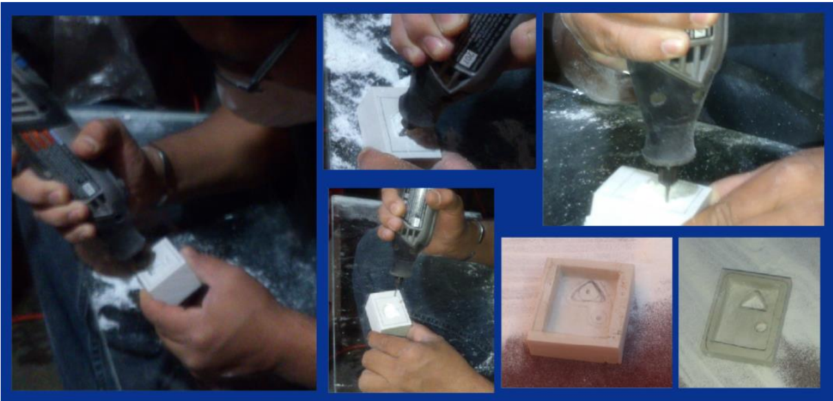
Figura 4.2. Se puede apreciar en la imagen que al ir maquinando el material se tiene que estar retirando el excedente para darle forma al modelo físico.
