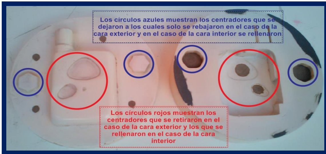
Figura 4.9. Se muestran los centradores de la cara exterior y la cara interior.
