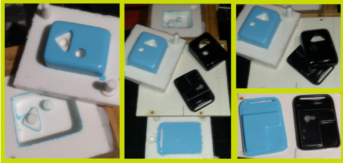
Figura 4.5. Se aprecia algunas réplicas del modelo del control tomadas de un molde de silicón, el cual copia hasta el más mínimo detalle del original.
