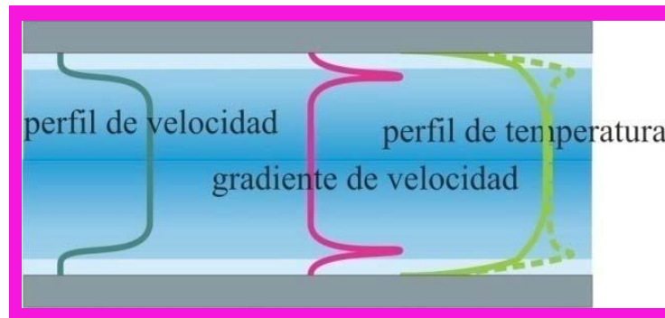
Figura 7.5. Perfil de velocidad de flujo, gradiente de velocidad y temperatura durante el llenado de un molde.
