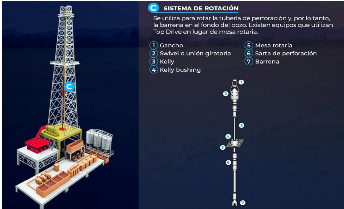
Ilustración 2. Sistema rotatorio, fuente: Comisión Nacional de Hidrocarburos.
