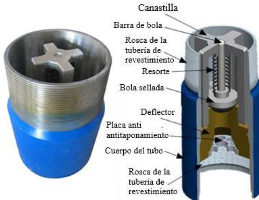
Ilustración 14. Cuello Flotador, modificada de: (SHANDONG RUNDONG PETROLEUM MACHINERY, n.d.)
