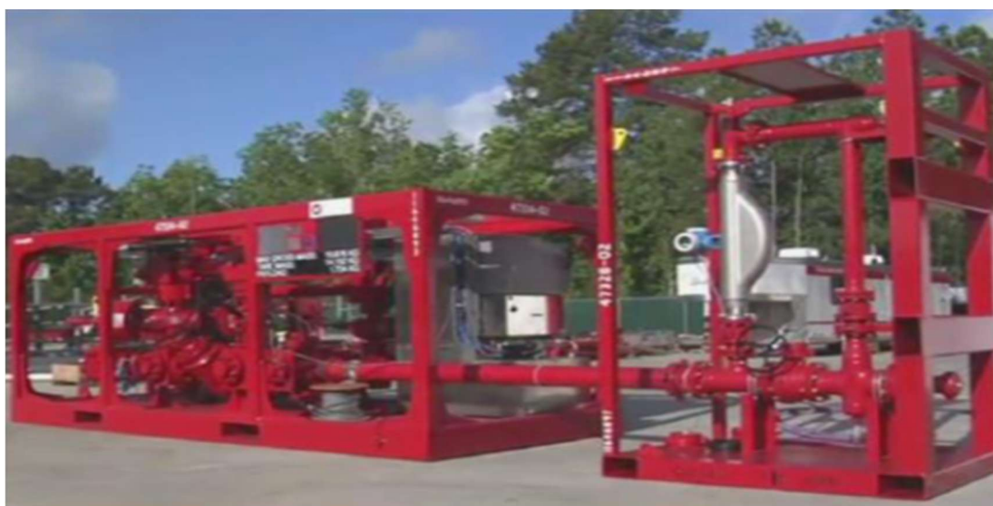
Ilustración 40. Estrangulador MPD Automatizado, fuente: (Antonio Balanza et al., 2015)
