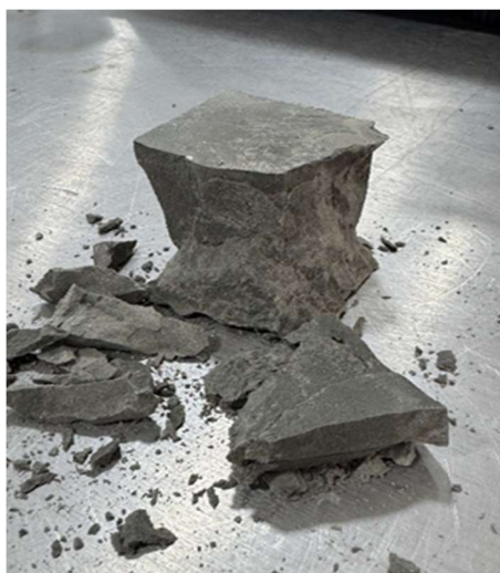
Ilustración 52. Cubo de cemento después de la prueba de resistencia
