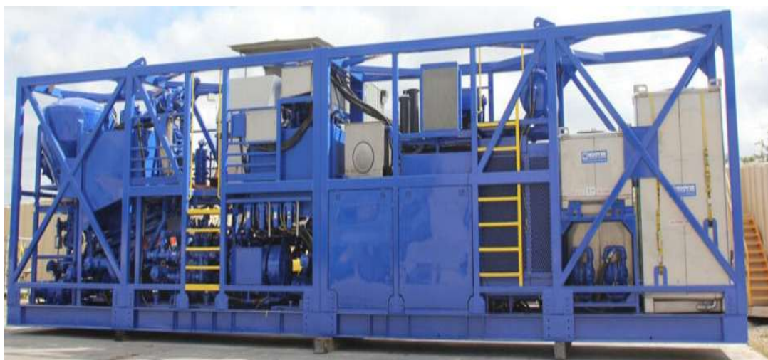
Ilustración 11. Unidad de cementación marina Fuentes: (Comansum, n.d.)
