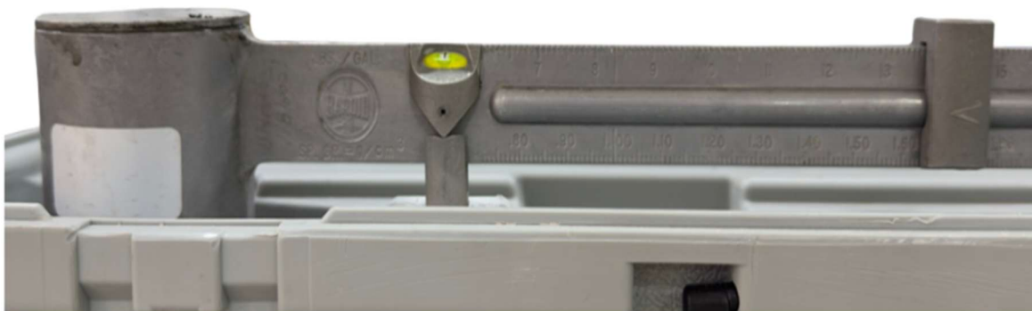
Ilustración 50. Fotografía de la balanza de lodos con la lechada de cemento dentro de la copa
