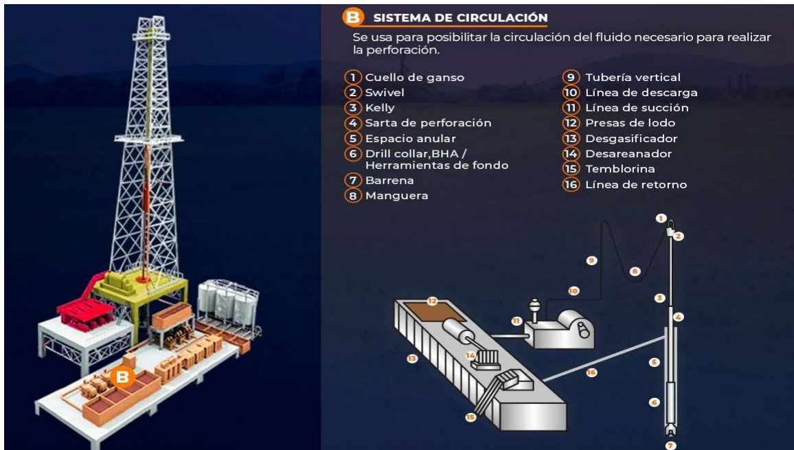
Ilustración 3, Sistema de Circulación, fuente: Comisión Nacional de Hidrocarburos.
