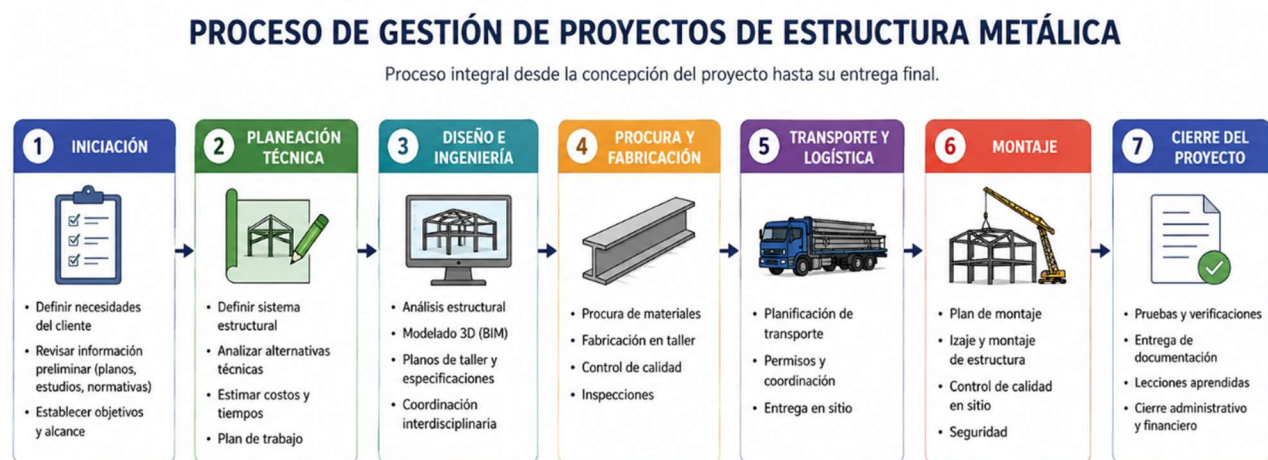
Ilustración 5. Proceso de gestión de proyectos de estructura metálica
