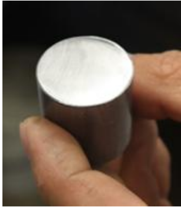
Figura 11. Probeta después de ser desbastada. Grano 400 (izquierda) - Grano 500 (derecha).
