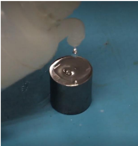
Figura 22. Aplicando unas gotas de nital sobre la superficie con acabado espejo de la probeta.
