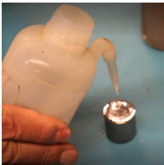
Figura 19. Aplicando alcohol sobre la superficie de la probeta.
