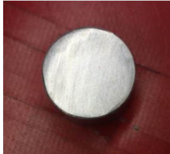
Figura 10. Probeta después de ser desbastada. Grano 240 (izquierda) - Grano 360 (derecha).
