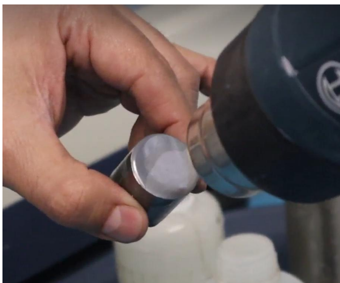
Figura 24. Secando el alcohol restante con la pistola de aire.
