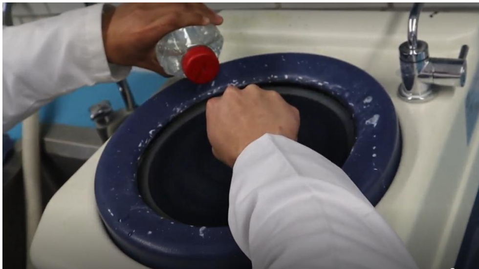
Figura 17. Estudiantes puliendo la probeta con alúmina blanca.
