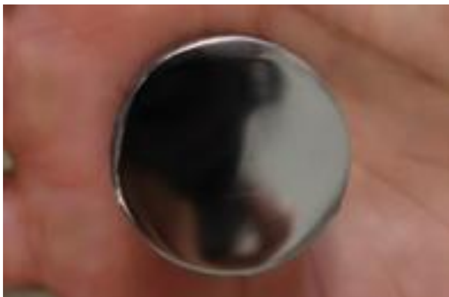
Figura 18. Probeta después de ser pulida con alúmina blanca
