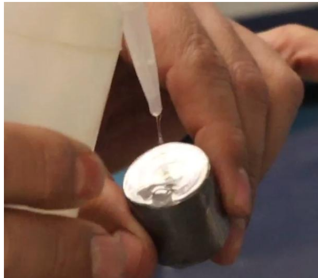
Figura 23. Interrumpiendo el ataque químico con alcohol.
