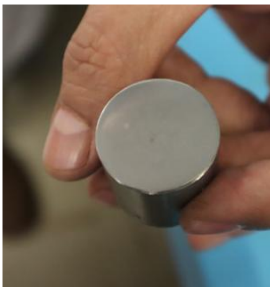
Figura 25. Probeta después de realizar el ataque químico.
