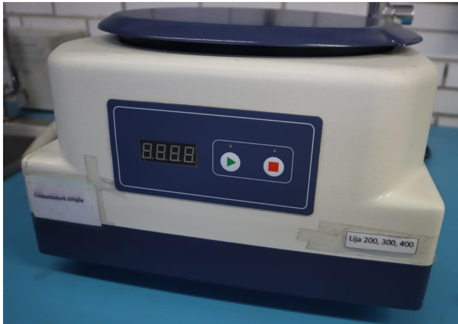
Figura 57. Fotografía de una desbastadora disponible en el laboratorio de Ingeniería de Materiales de la Facultad de Ingeniería - UNAM
