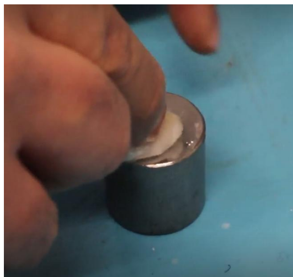
Figura 20. Secando el alcohol de la probeta con algodón.
