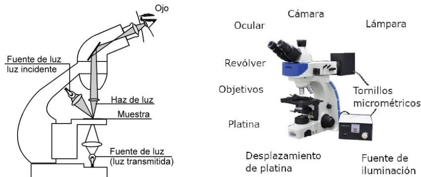
Figura 3.2. Microscopio metalográfico convencional (de reflexión) de luz visible y partes importantes.
