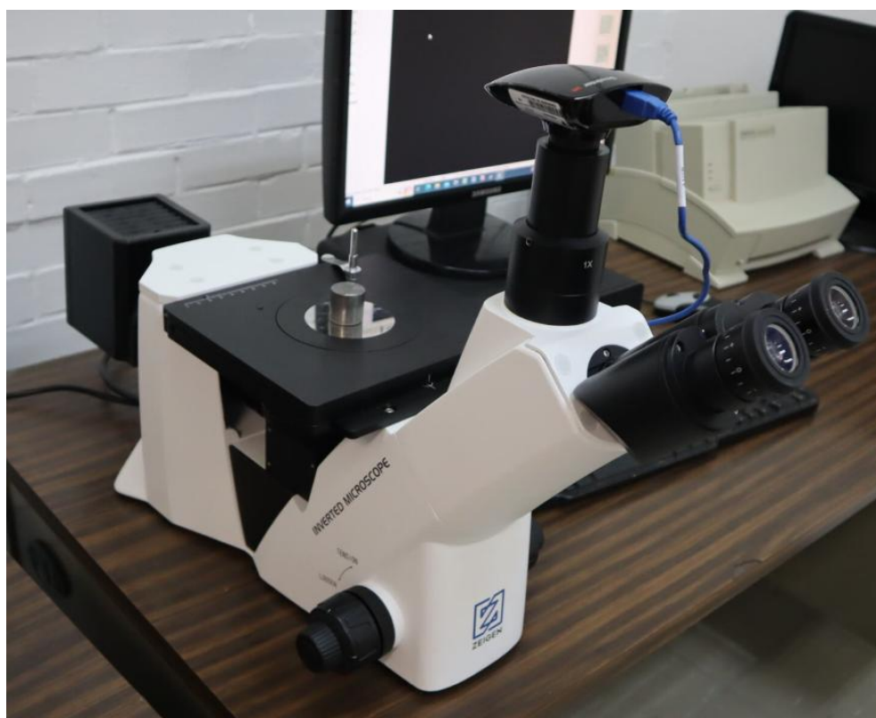
Figura 26. Probeta lista para ser observada en el microscopio.
