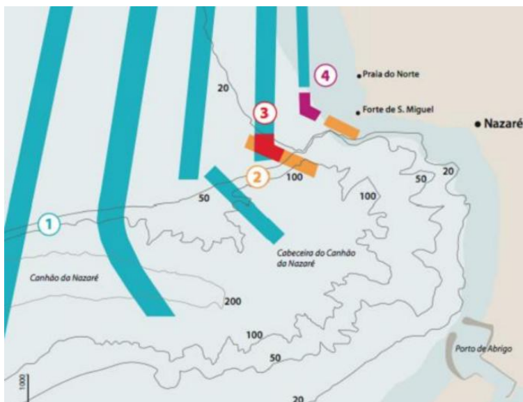
Figura 20. Refracción y focalización del oleaje sobre Nazaré. Tomado de: Portuguese Hydrographic Institute (2022).
