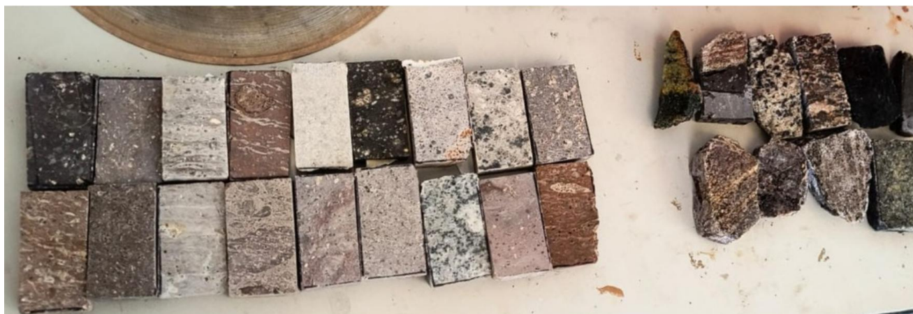
Figura 4.2. Fotografías del proceso de preparación de secciones delgadas a partir de xenolitos.
