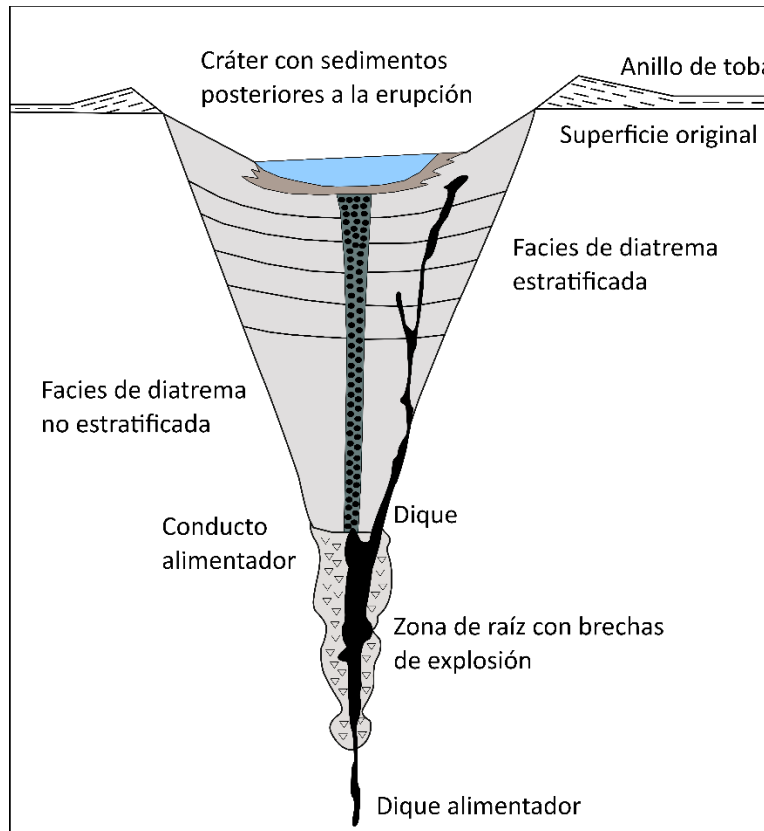
Figura 2.2 Modelo esquemático de un sistema volcánico tipo maar-diatrema, que muestra el cráter con sedimentos posteriores a la erupción, el anillo de toba, la superficie original, las facies de diatrema estratificada y no estratificada, el conducto alimentador, los diques y la zona de raíz con brechas de explosión. Modificado de Lorenz (20003) y White & Ross (2011)
