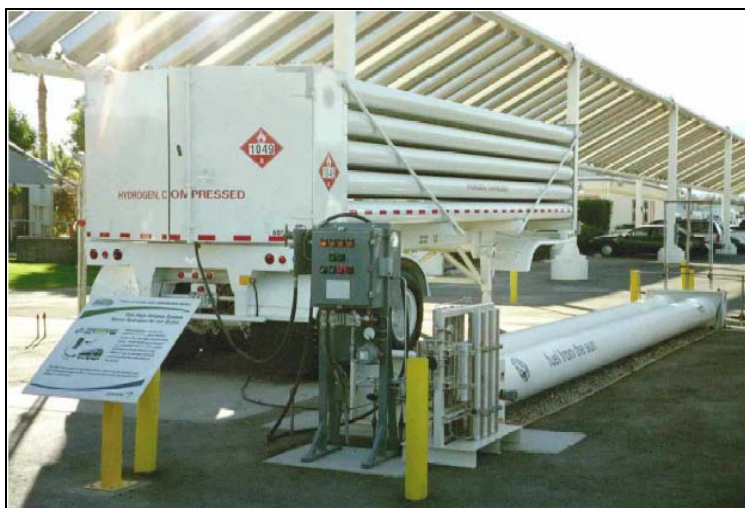
Figura 5.11 Transporte de H 2 por medio de trailers o remolques (Fuente: WWEA, 2006)
