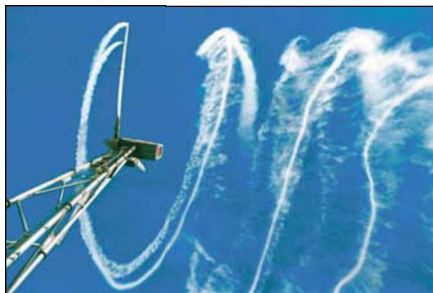
Figura 4.19 Efecto estela de un aerogenerador (Fuente: www.windpower.dk )
