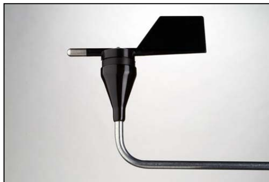
Figura 3.7 Veleta típica para la medición de la dirección del viento
