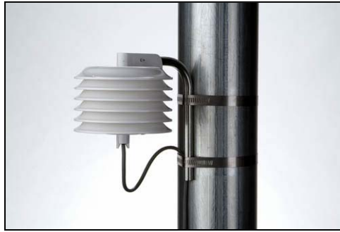
Figura 3.8 Sensor para la medición de temperatura (Fuente: NRG Systems)
