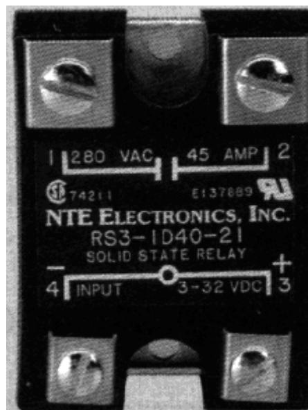
Figura 3.19 Interruptor de estado sólido 280 Volts a 40 Amperes (Entrada de 3 a 32 Volts de C.D.)
