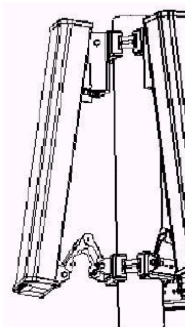
Figura 5-27 Cuando la polarización es negativa (Uptilt) el soporte superior se pone como inferior y el soporte inferior como superior.
