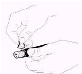
Figura 5-34 Colocación de la grasa
