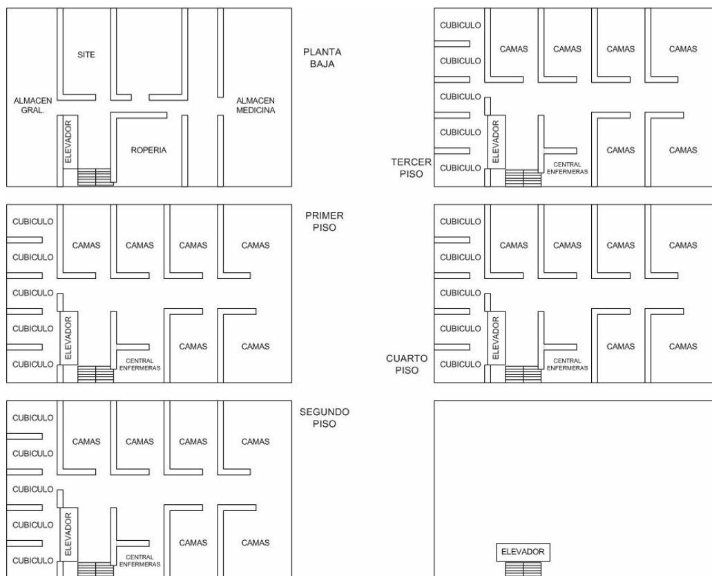
Figura 3.10. Distribución interna del edificio de Hospitalización.
