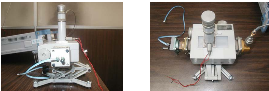
Figura 3.4: Placa para pruebas montada a la salida de la línea ranurada.
