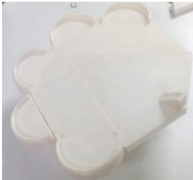
Figura 45 - Plato de Coriolis, impreso en PLA blanco.
