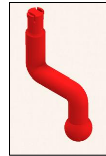
Figura 3.10 Manivela flecha y eslabón.
