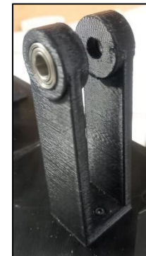
Figura 5.20. Base de polea primaria impresa.
