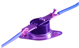
Figura 8.21 Termostato bimetálico. Cuando la temperatura hace que el metal en su interior se expanda, abre el circuito entre sus terminales e interrumpe el flujo de corriente entre ellas, así puede encender o apagar un actuador, como una resistencia que esté disipando calor.
