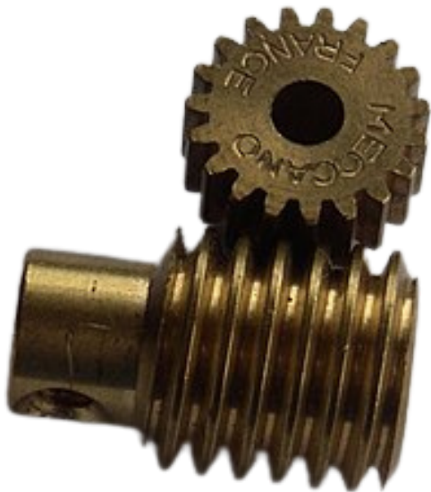
Figura 7.24 Tornillo sin fin con piñón
