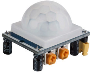
Figura 11.3 Una lámpara con sensor de movimiento usa un sensor infrarrojo pasivo (PIR), para detectar cambios en la radiación infrarroja del lugar.
