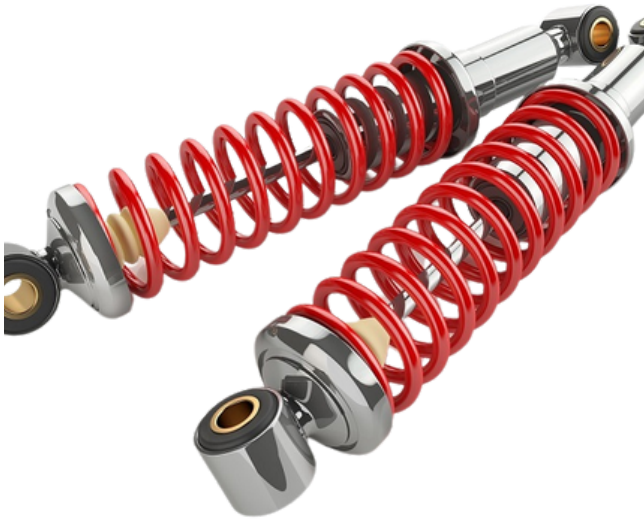
Figura 7.10 Los amortiguadores de automóvil utilizan un resorte, también llamado muelle, y un cilindro de aceite, los cuales generan un amortiguamiento viscoso.
