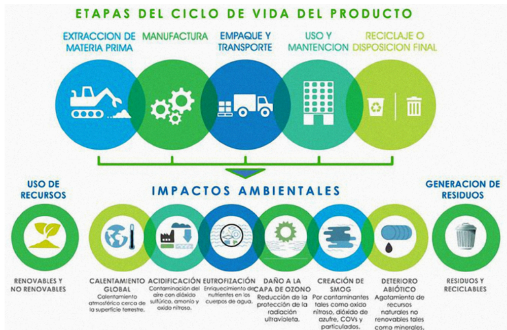
Figura 11.4 El ciclo de vida de cualquier sistema implica la extracción de materia prima, la manufactura, el empaque y transporte, uso y mantenimiento, así como la disposición (reutilización, reciclaje o desecho). En cada etapa, todo sistema genera impactos ambientales y residuos.
