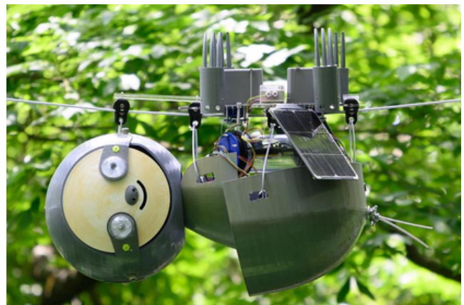
Figura 10.27 Robot Sloth donde se aprecian las celdas solares para su alimentación
