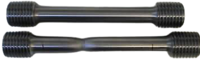
Figura 4.17 Probetas de acero antes (probeta superior) y después (probeta inferior) del ensayo de tracción. Mientras más resistente sea el material a la tracción, la longitud de la zona estrechada será mayor.
