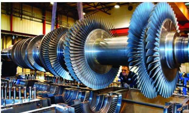
Figura 3.1 Interior de turbina de vapor, la cual se usa en las centrales eléctricas para convertir el calor del vapor en energía eléctrica. La termodinámica ayuda a hacer más eficiente este proceso de conversión de energía.
