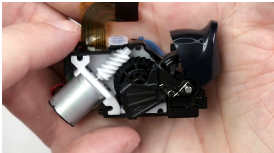
Figura 6.11 Mecanismo del gatillo háptico del control DualSense de PlayStation con actuador lineal
