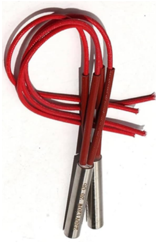
Figura 10.13 Heater cartridge para impresora 3D. El microcontrolador manda una señal para activarlo, sin embargo, se requiere una etapa de potencia (ver sección 5.3) para darle la suficiente corriente para que eleve la temperatura; el microcontrolador no puede hacerlo por sí solo.
