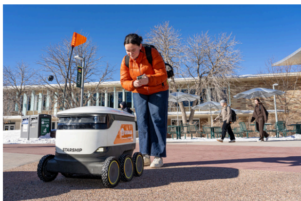
Figura 10.17 El robot Starship en el campus de la Universidad del estado de Colorado en Estados Unidos, se utiliza para realizar entregas de pedidos.
