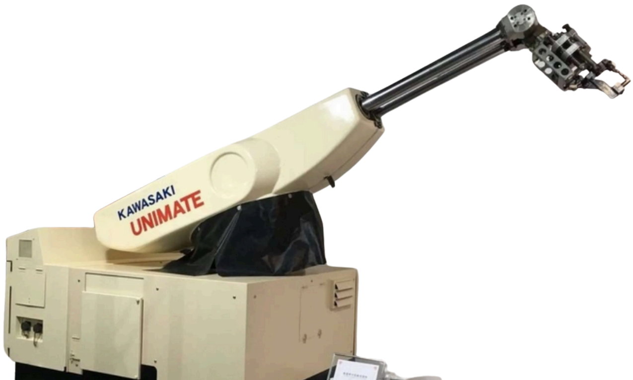
Figura 10.16 El Unimate fue conceptualizado y construido por George Devol, quien lo patentó en 1954. El Unimate era un brazo robótico hidráulico, capaz de realizar tareas repetitivas como la manipulación de piezas fundidas y la soldadura en la industria automotriz.
