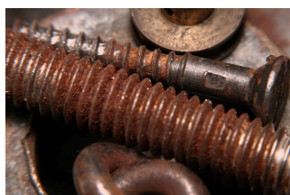
Figura 4.16 Elegir materiales que sean resistentes a la corrosión es importante si la pieza que se fabrica estará expuesta al ambiente.
