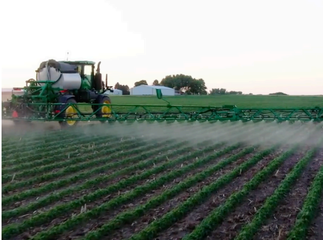
Figura 10.22 Tecnología Blue River's See & Spray implementada en un tractor para desmalezamiento químico. Detecta el tipo de maleza y aplica la cantidad exacta de químico.
