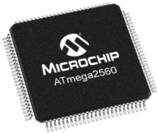
Figura 10.11 El ATmega2560 es un chip “todo-en-uno” que controla dispositivos electrónicos de forma autónoma (aunque hay que hacer un programa para decirle qué hacer). Es uno de los muchos microcontroladores que se pueden encontrar en el mercado.
