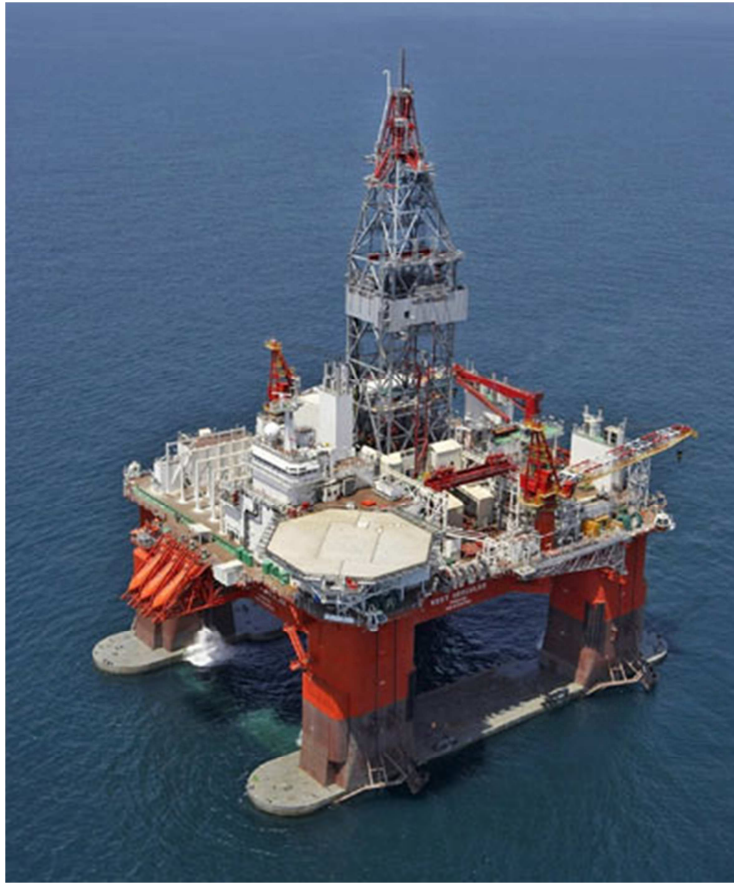
Figura 9: Plataforma de perforación semi-sumergible convencional.
