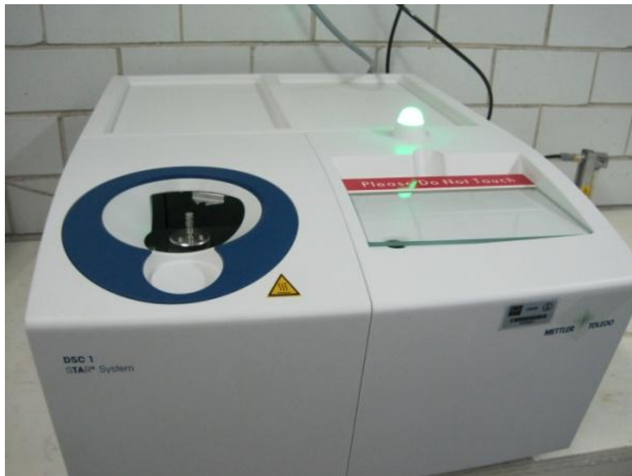
Figura 17. Fotografía del calorímetro DSC-1
