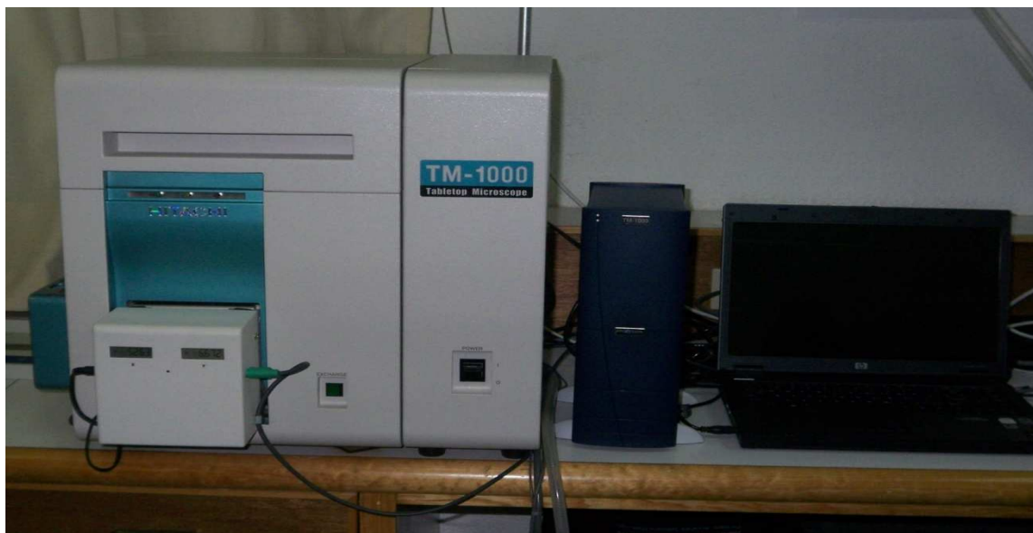
Fig. 13. Microscopio electrónico de barrido marca Hitachi TM1000 utilizado en este trabajo, se encuentra acoplado a un CPU y una computadora portátil HP que tiene instalado el software de aplicación.
