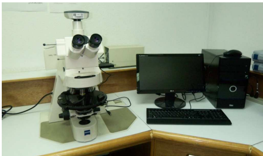
Fig. 12. Fotografía del microscopio petrográfico utilizado para realizar la caracterización mineragráfica y petrográfica. El microscopio es acoplado a una cámara digital y una computadora que incluye el software AxioVision, especializado para la obtención de las microfotografías del presente estudio.
