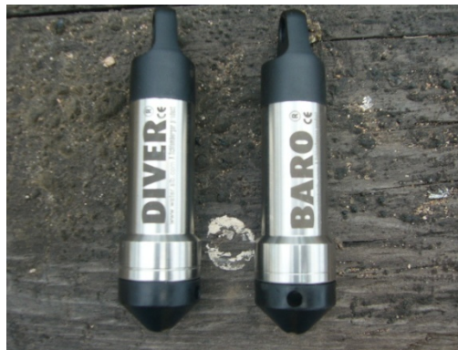
Figura 3.2 Divers utilizados en la prueba de bombeo.
