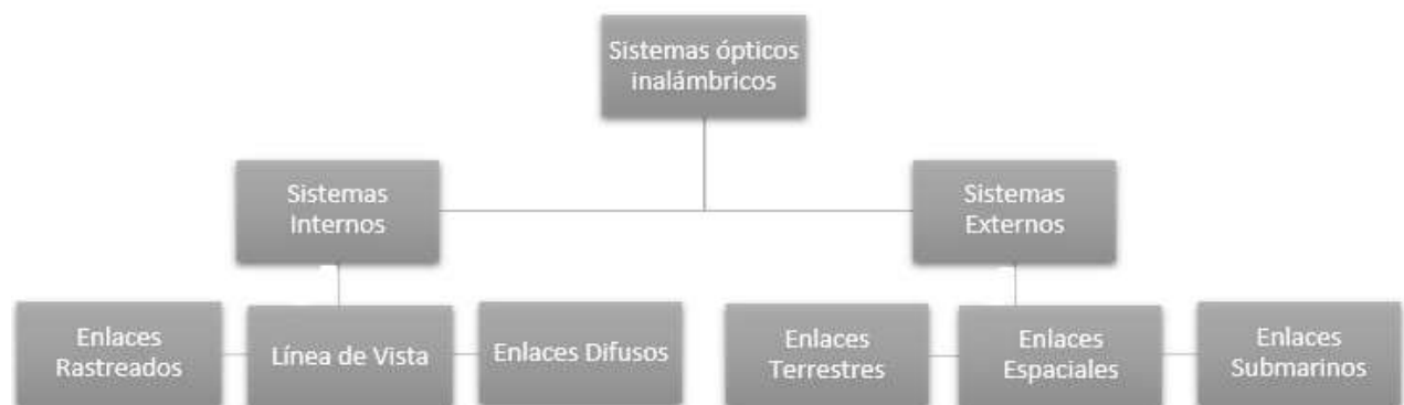
Figura 8. Subdivisiones de los sistemas ópticos inalámbricos. [21]
