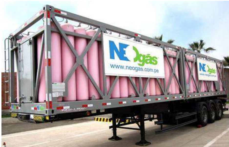
Figura 42, Módulos de almacenamiento, Neogas.
