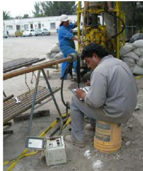
Fotos 6, 7, 8 y 9. Ejecución de los sondeos de cono eléctrico. Se realizaron cinco sondeos, uno en cada vértice del terreno y uno al centro; se realizaron hasta detectar la capa dura, la cual se detectó a una profundidad promedio de 29.2 m.
