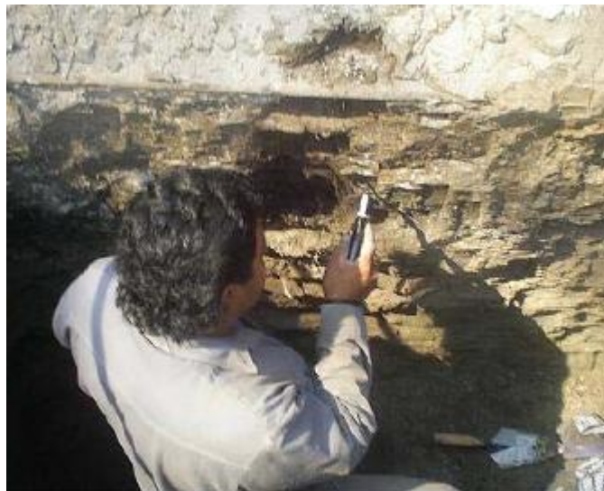
Foto 1. Trabajos en los pozos a cielo abierto. Medición de la resistencia del suelo, en campo, con el penetrómetro de bolsillo; se realizaron mediciones a cada 10 cm.
