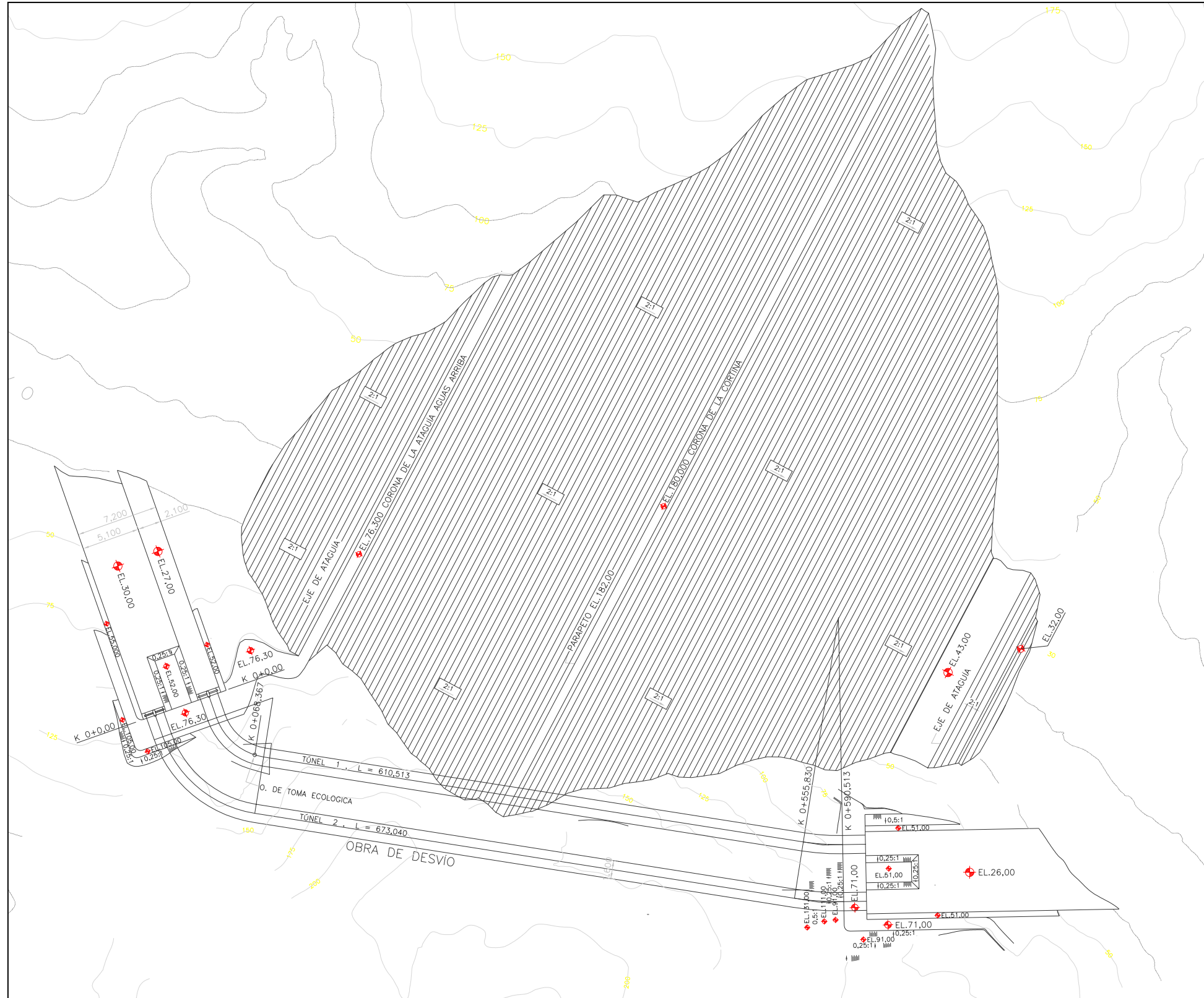
Figura 4.1. Arreglo general de la Obra de desvío para alternativa ENA en el P.H. La Parota
