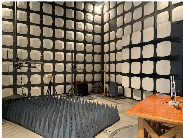
Figura 5.6: Vista general de la cámara semianecoica utilizada para los ensayos de emisiones radiadas en campo lejano, mostrando la disposición del equipo bajo prueba y la instrumentación de medición.
