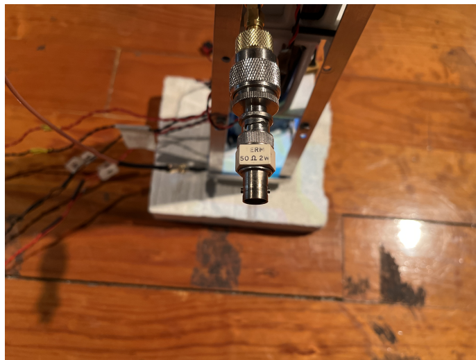
Figura 5.7: Terminación de la salida RF del rastreador comercial mediante una carga de 50\ \Omega , utilizada para evitar transmisiones intencionales durante los ensayos de emisiones radiadas.
