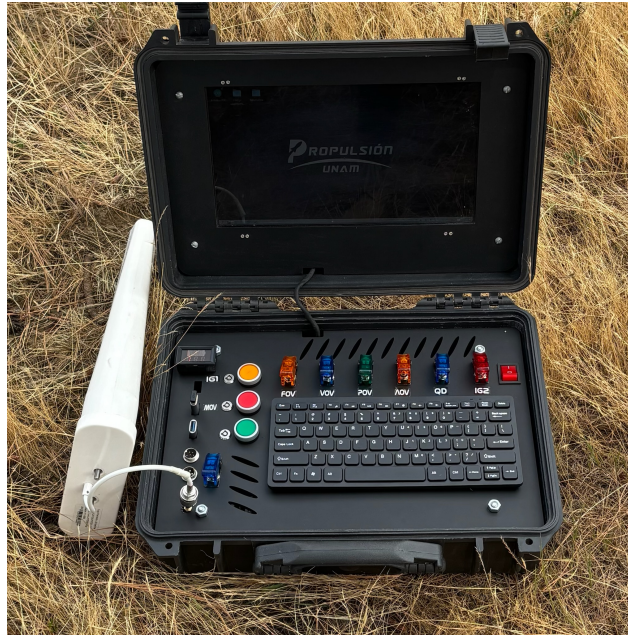
Figura 3.13: Estación terrena que ayuda a visualizar los datos en tiempo real
