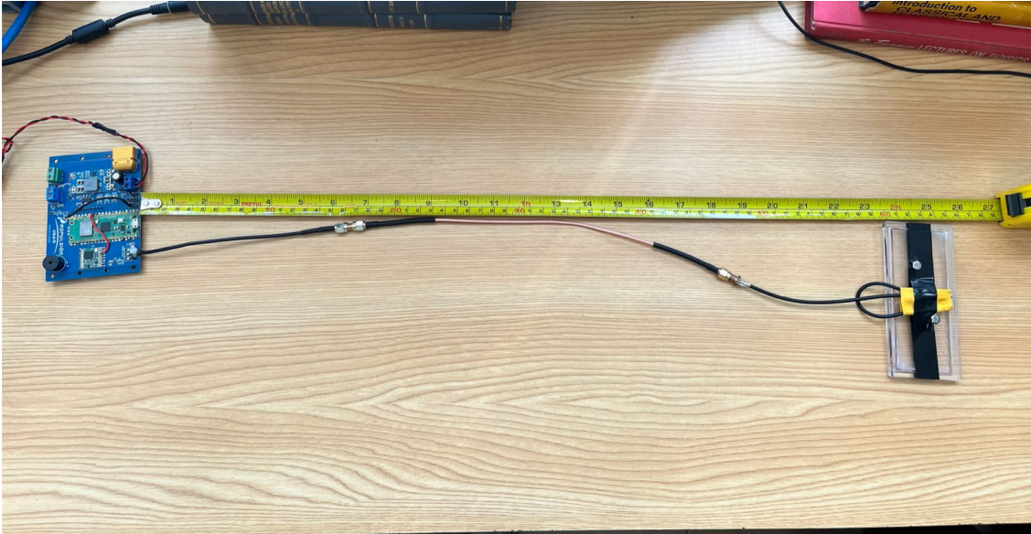
Figura 6.4: Medición física del cable coaxial que conecta la computadora de vuelo con la antena Moxón
