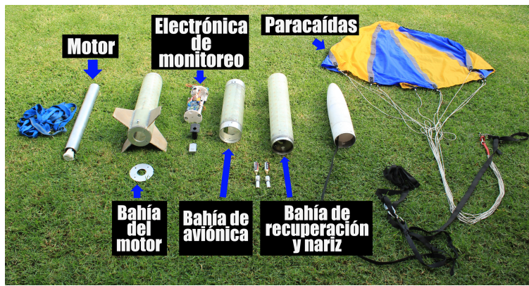
Figura 3.2: Partes del cohete experimental Komodo AP, lanzado y recuperado por Propulsión UNAM en 2023
