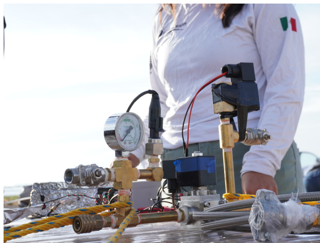
Figura 3.8: Estación de llenado de N_2O para el motor "Castigador V2"
