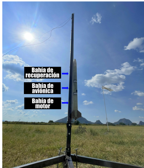
Figura 3.5: Representación de las partes internas de un cohete experimental (en la imagen, el Komodo AP antes de su lanzamiento en octubre de 2023).
