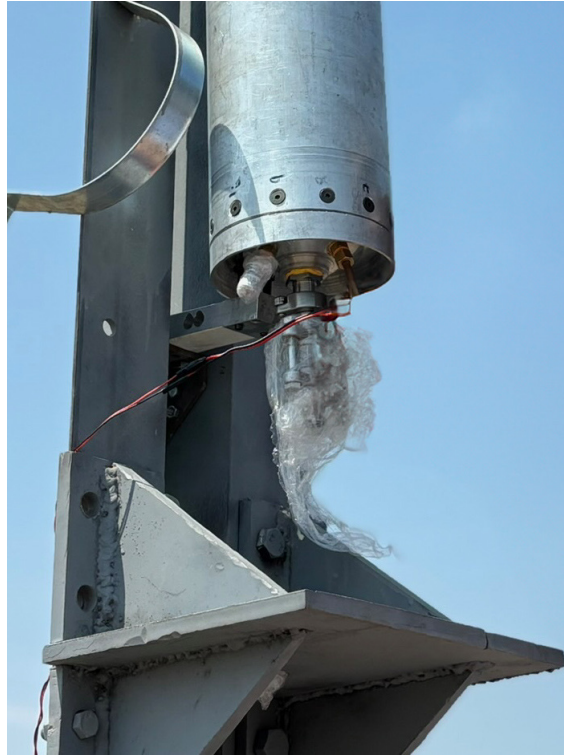
Figura 3.12: Ensamble de celda de carga para el monitoreo de la masa del oxidante en el "Castigator V2"
