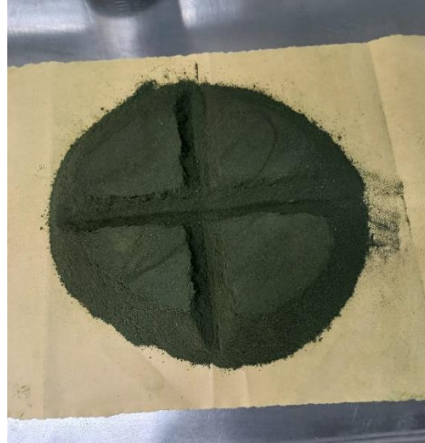
Figura 4. Cuarteo de la biomasa microalgal para la selección de muestras a hidrolizar
