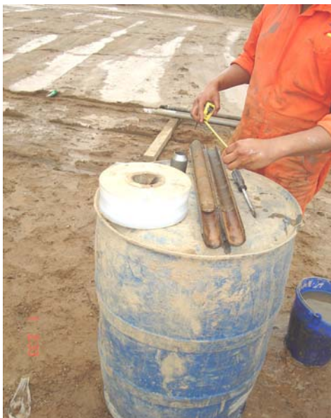
Fig. 5,23 Sondeo de penetración estándar posteriores a los trabajos de compactación dinámica.
