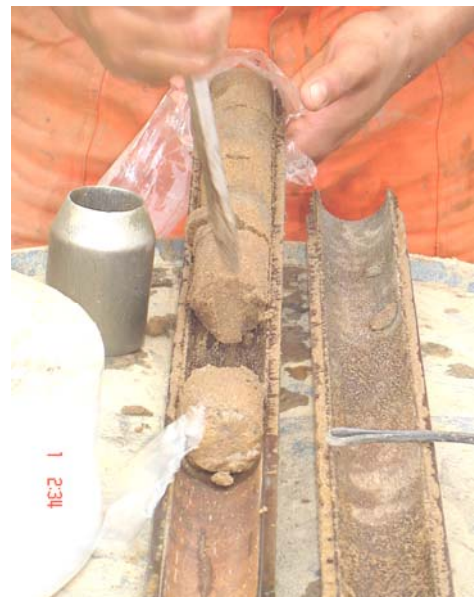
Fig. 5,23 Sondeo de penetración estándar posteriores a los trabajos de compactación dinámica.
