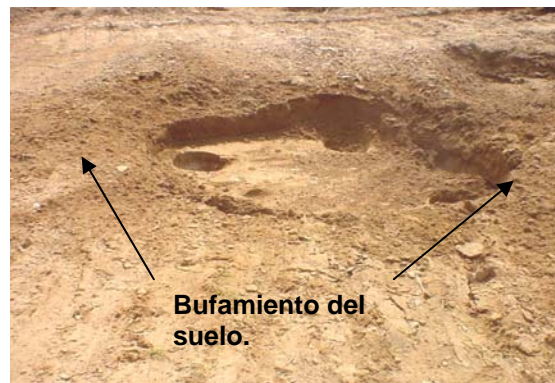
Fig. 3.4 Esfuerzo del suelo adyacente a los cráteres.
