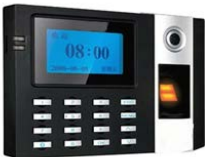
Detector Biométrico de huella digital con teclado y display.
