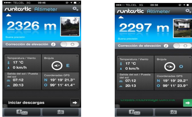
Imagen 1. 6 Diferencia de alturas utilizando Altimeter en Smart Phone
