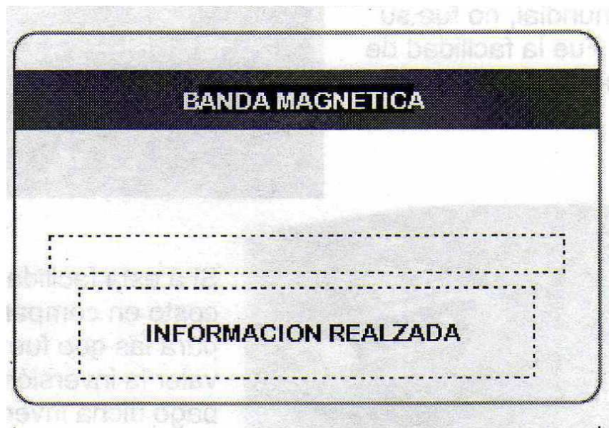
Fig. 2.1 Ubicación de banda magnética y datos escritos en la tarjeta
