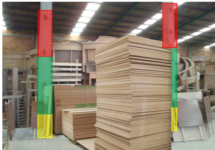
Figura VI-3 Ejemplo de Kanban en las columnas de las instalaciones
