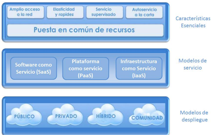
Figura 2.1 Representación visual de la definición de NIST del cómputo en la nube.
