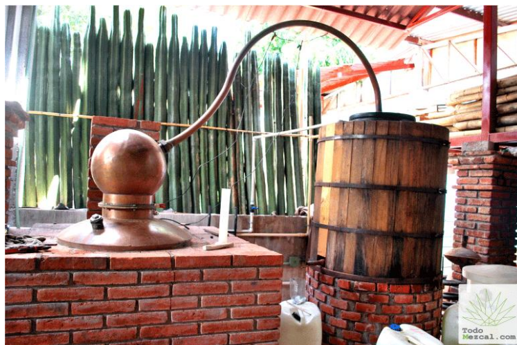
Figura 1.28 Alambique de cobre enfriado con agua
