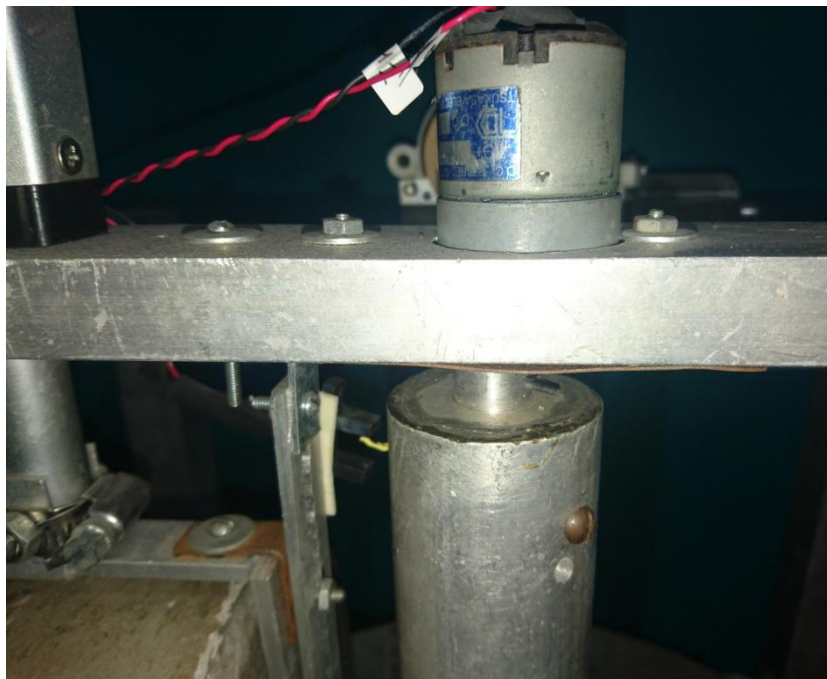
Figura 3.22 Acoplamiento del motor con el eje principal
