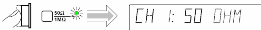
Figura 3.20 Selección de la impedancia de entrada del canal 1.
