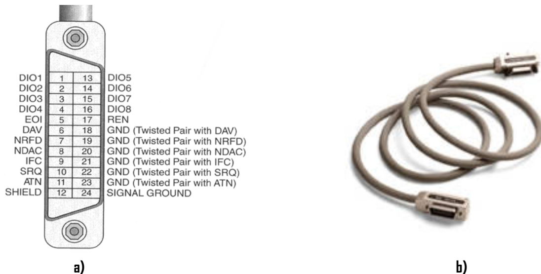
Figura 4.2 Bus GPIB. a) Conector y terminales. b) Cable GPIB-GPIB de NI.
